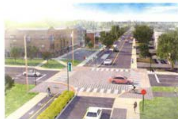
Fig. 141. Intersection surélevée (Source : Ville Sainte-Catherine).
