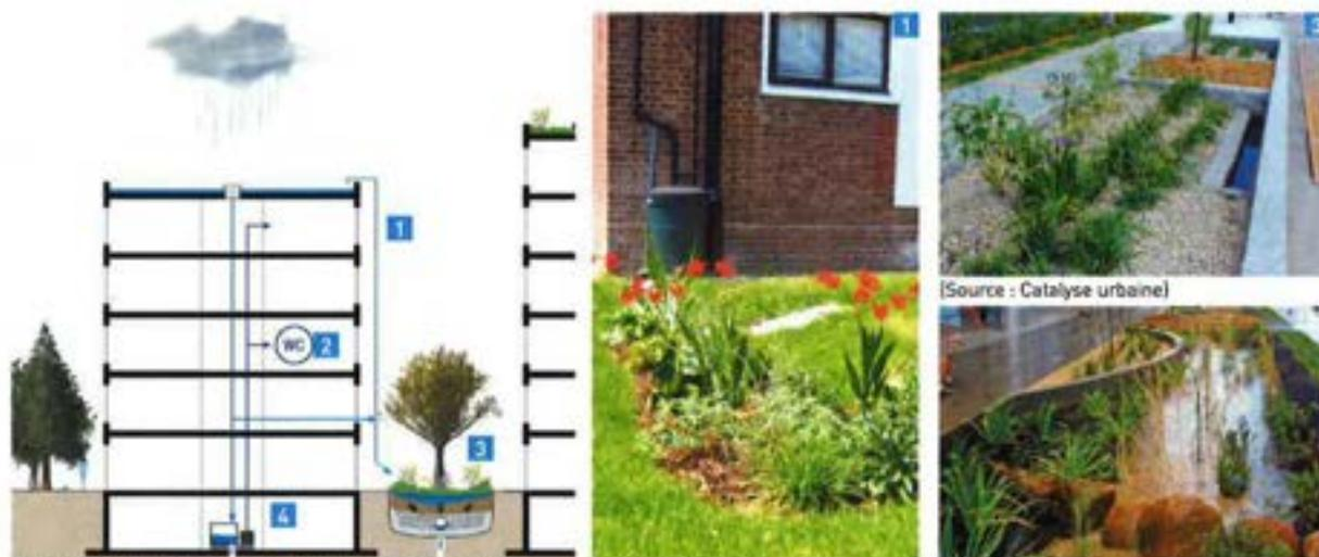
Fig. 163. Bâtiment intégrant des mesures de gestion de l'eau (Source : Vinci).
